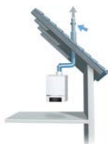
Nasávání spalovacího vzduchu z venkovního prostoru.
