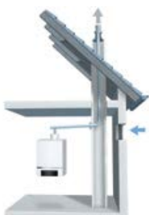
Nasávání spalovacího vzduchu z místnosti instalace.
